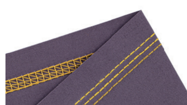
Point de recouvrement 4 fils ( 6 mm ) pour ourler les matières très élastiques, pour effets fantaisie
